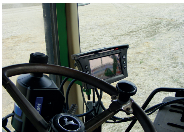
Figura 6. Sistema de guiado automático móvil "EZSteer" acoplado al volante del tractor
