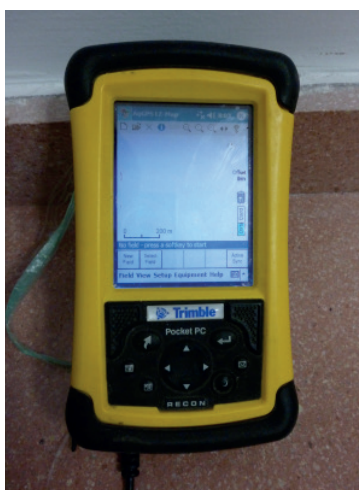
Figura 14. Pocket pc con programa EZ Maps para toma de muestreos en campo
