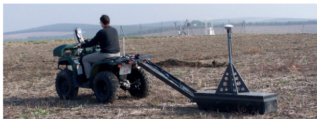
Figura 15. Sonda EM 38 arrastrada por quad
