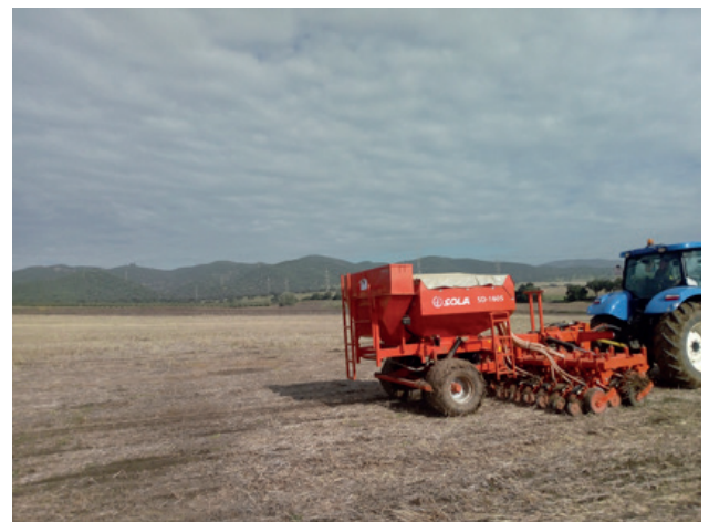
Figura 23. Sembradora directa con tolva para la semilla junto al tractor y tolva trasera de abono microgranulado.
