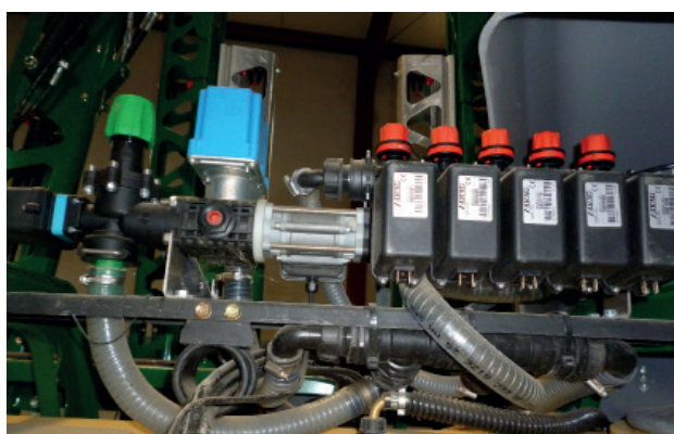
Figura 16. Caudalímetro aforador instalado en una barra de aplicación preparada para la dosificación variable de abono líquido
