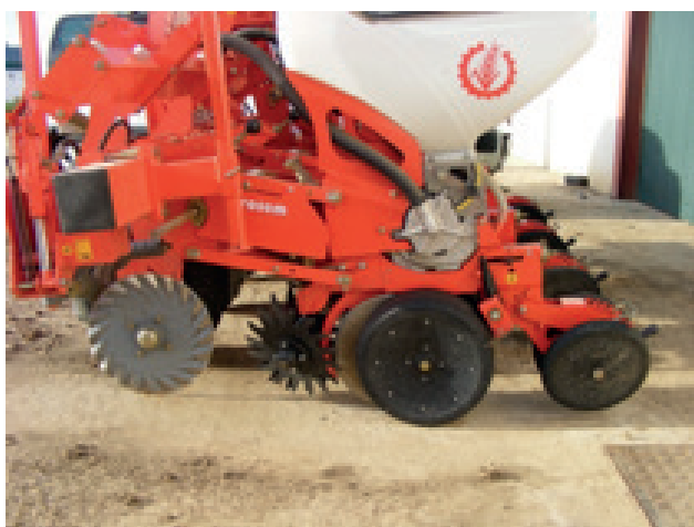
Figura 2. Ejemplo de equipo siembra directa compuesto de (comenzando por la izquierda): disco de corte de residuos y preparación previa del terreno; discos tipo "soles" para despeje de restos sobre la línea de siembra; discos abresurcos (van en forma de V) con rueda de goma que actúa como control de profundidad. En el interior va el tubo que deposita las semillas en el suelo; por último, se sitúan los discos de cierre de surco.
