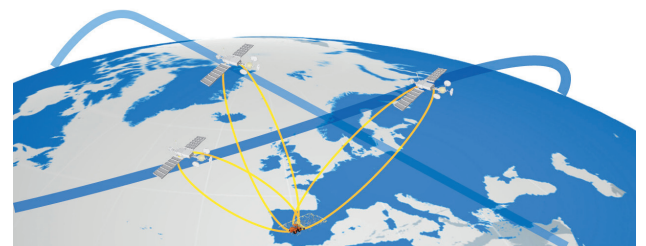
Figura 4. Triangulación para conocer las coordenadas de un punto terrestre
